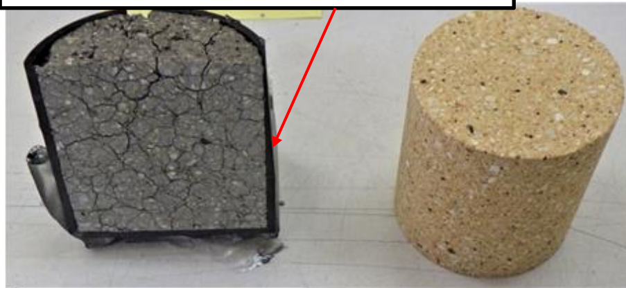
試験後の切断面・外観
